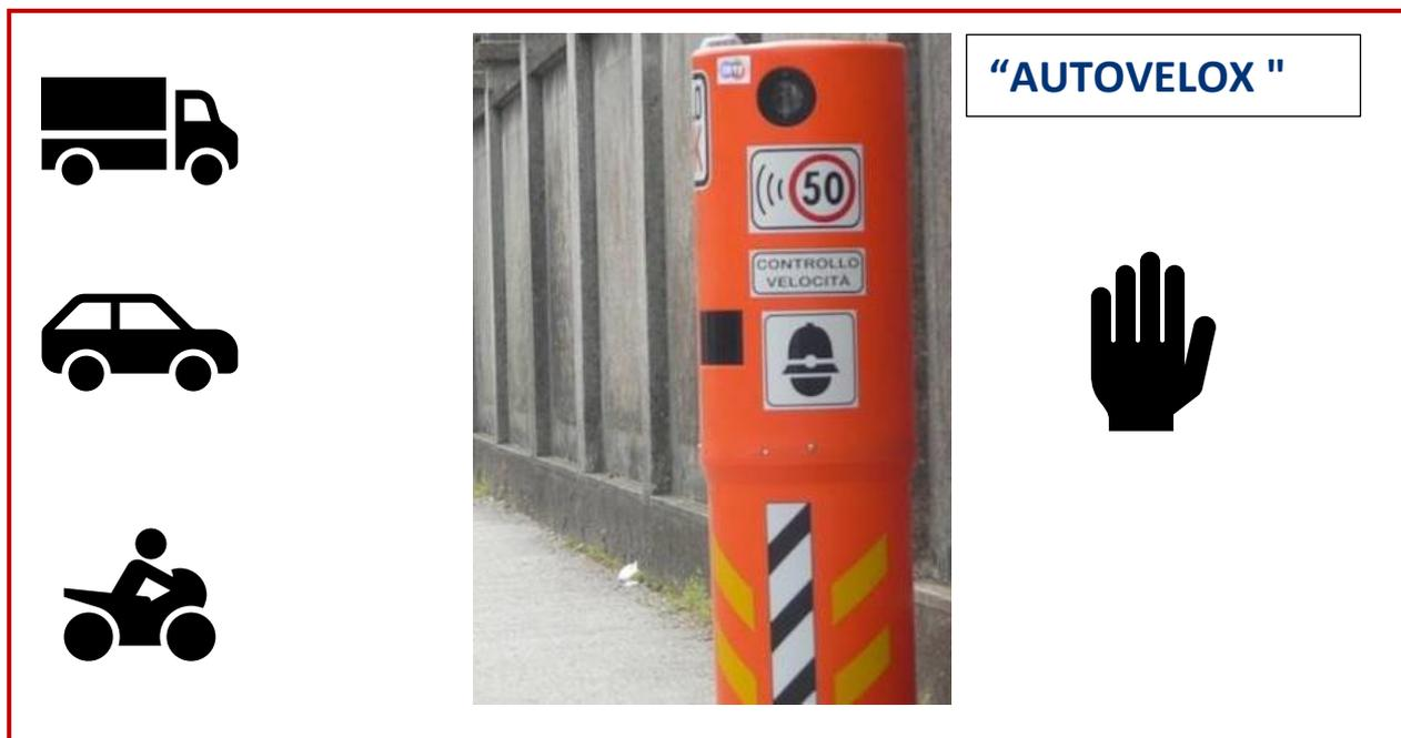
Il sistema Autovelox è un dispositivo in grado di rilevare il superamento dei limiti di velocità in un dato tratto stradale, documentandolo fotograficamente.
