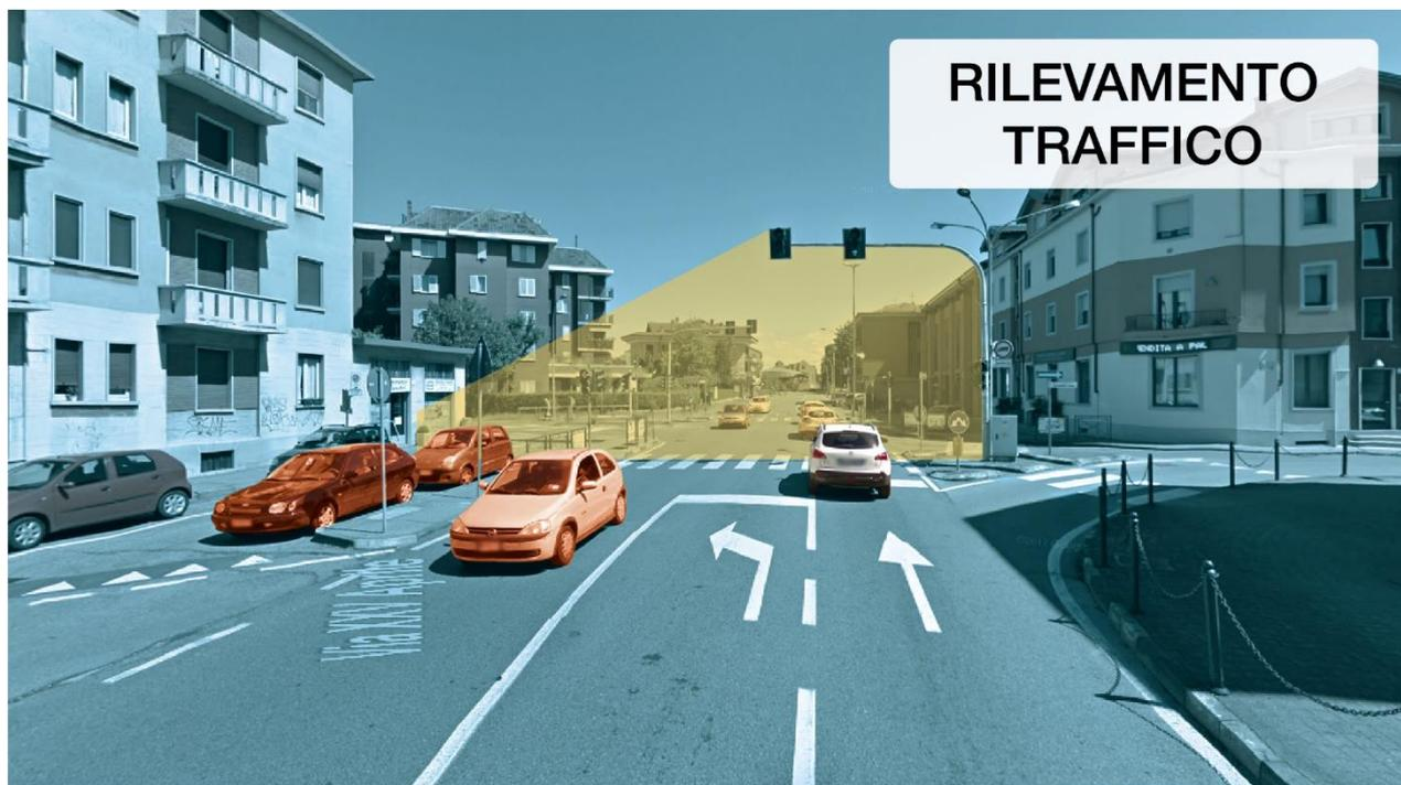
La proposta progettuale prevede la dotazione di 8 punti di monitoraggio dotati di telecamere che avranno il compito di analizzare il traffico veicolare attraverso il conteggio dei veicoli nelle varie ore del giorno e della notte. Ciascuna telecamera è dotata di un modulo di elaborazione e connettività in grado di raccogliere i dati di conteggio veicoli per direzione di flusso e di riportarli nella piattaforma.
