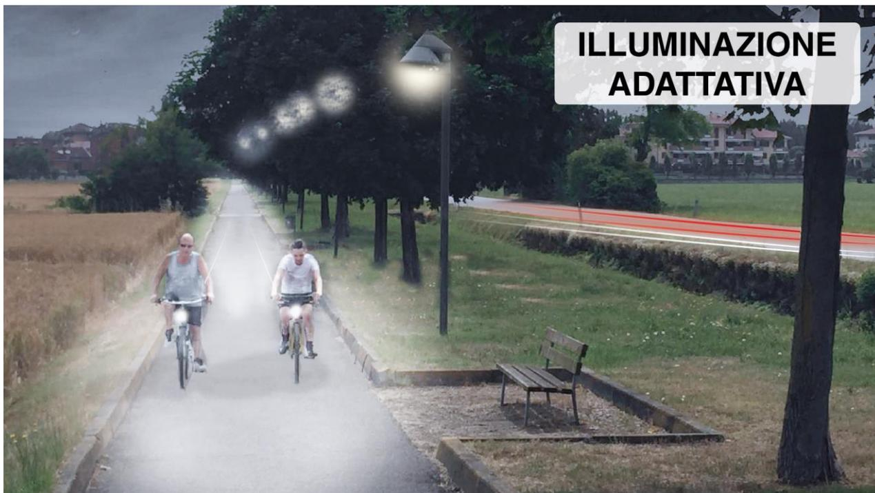
Il servizio di illuminazione Led adattiva consente, mediante l'uso di dispositivi di controllo presenza collegati alla piattaforma IoT, unitamente al sistema di illuminazione, di intercettare la presenza di persone o veicoli lungo percorsi ritenuti strategici, al fine di adattare il livello di illuminazione presente lungo il suo tracciato.
